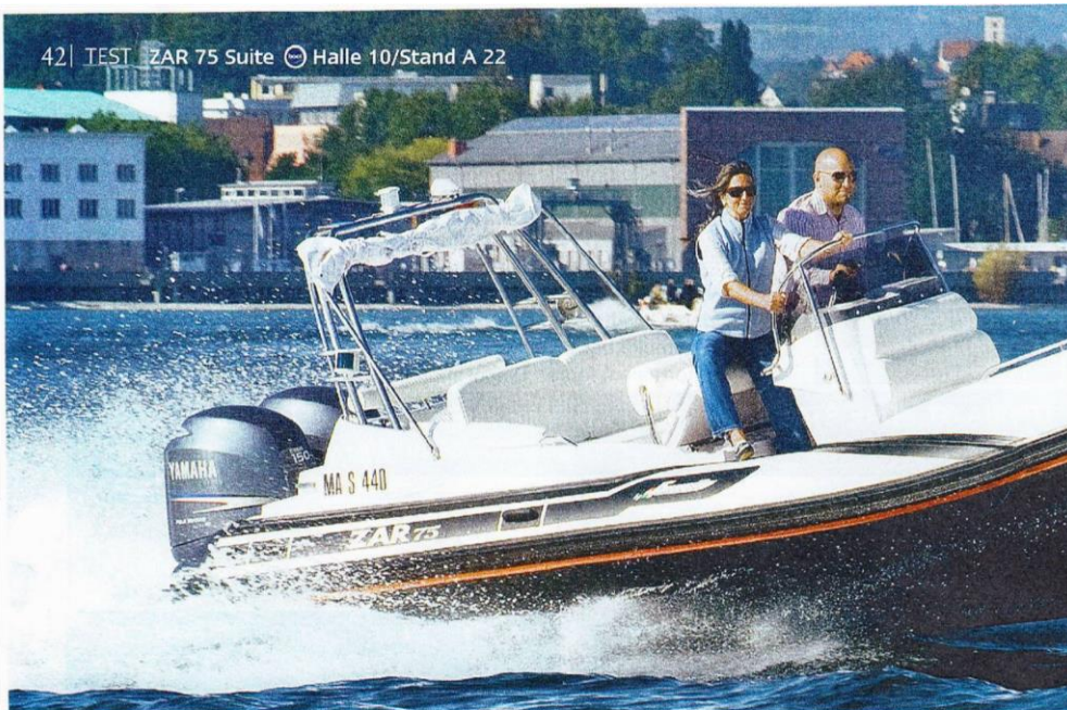
Mit den beiden Yamaha F150 am Spiegel erreicht die ZAR 75 Suite eine Höchstfahrt von 47,5 kn und läuft absolut trocken
