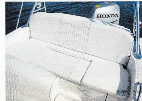
Breite Bank mit Schnellzugriff auf die Ausrüstung. Sperrigere Teile erreicht man durch Aufklappen der gesamten Bank
