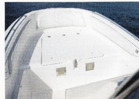
Wasserdichtes und belüftetes Staufach im Bug, auf dem auch eine Sonnenliege hergerichtet werden kann
