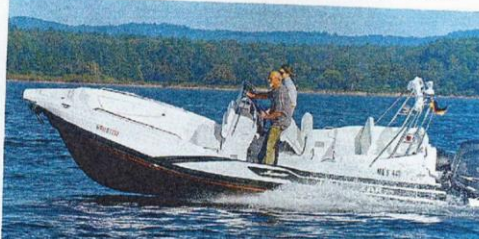
Die 57 cm im Durchmesser messenden Tragschläuche haben nur in schnell und eng gefahrenen Kehren Kontakt mit dem Wasser
